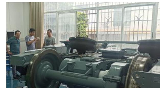
地铁转向架制动系统实验平台
